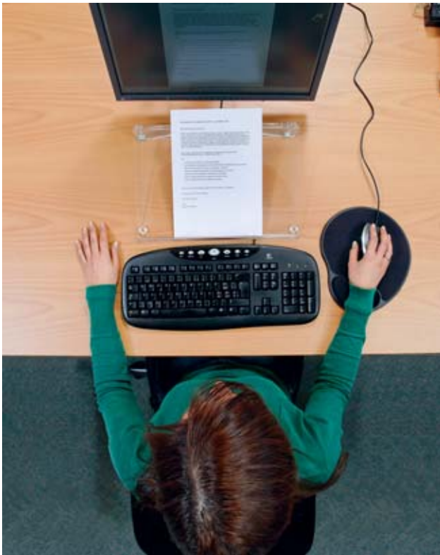
Bild 21: So sind Bildschirm, Tastatur, Maus und Schreibvorlage richtig platziert.
